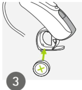
Coloque la pila en el portapilas con el símbolo "+" hacia arriba.
